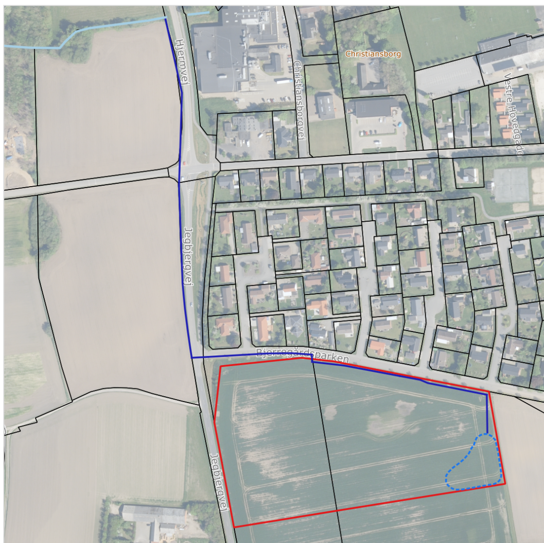
Figur 1.1: Placering af regnvandsbassin er markeret med stiplet blå linje. Udløbsledning fra regnvandsbassin til udløbspunkt i Hjern Bæk er markeret med mørkeblå linje.
